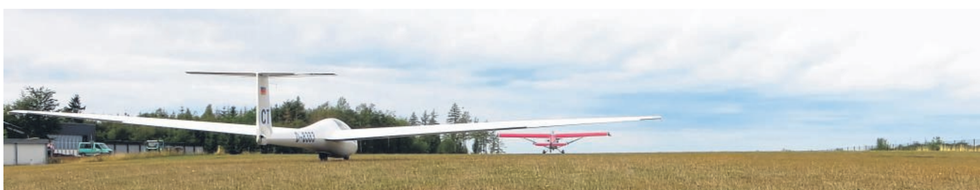
Die rote „Husky“ zieht mit ihren 180 PS die 500 Kilogramm schwere ASK21 locker in die Luft.
